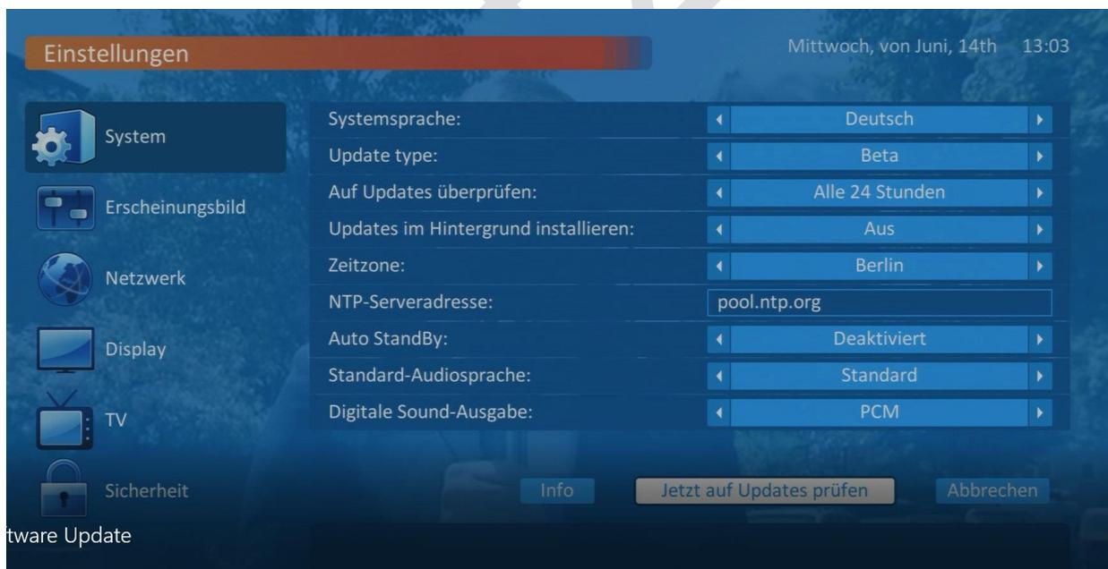
Es wird online nach Updates gesucht. Ist ein Update vorhanden wird es angezeigt und Sie werden gefragt, ob Sie es installieren wollen. Wenn ja, mit OK bestätigen. Update wird installiert und anschließend wird die Box neu gestartet.
